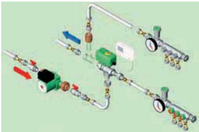
Рис. 30. Напольное отопление в одном помещении с регулирующими коллекторами MultiFAR
