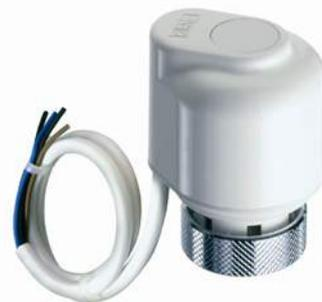
Когда термостат или узел контроля, к которому присоединена электротермическая головка, передаёт сигнал, внутренний элемент головки нагревается, и происходит перемещение штока клапана. Таким образом, вентиль открывается. Полностью открытое положение вентиля можно определить по выдвинутому круглому индикатору в верхней части головки. Так как головка нормально закрытого (НЗ) типа, то без электричества вентиль вновь закроется.
