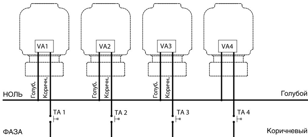
**Электротермический привод обеспечен двумя проводами:**
