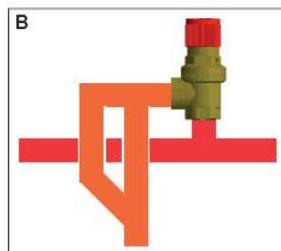
Схема установки предохранительного клапана SOLAR-FAR (код 2006) в систему солнечного обогрева.
