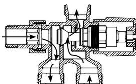
Вентиль открыт, байпас частично закрыт. Теплоноситель идёт через отопительный прибор
