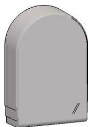
Датчик температуры наружного воздуха должен устанавливаться на Северной или Северо-Восточной стороне здания, на стене, куда не попадают прямые солнечные лучи, внезапные воздушные потоки или другое тепловое излучение, в защищенном от постороннего вмешательства месте. Высота установки датчика не менее 3 м от уровня земли. Монтаж датчика на стене осуществляется с помощью дюбелей (в комплект поставки не входят).
