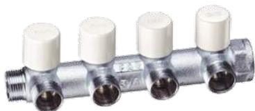
Коллекторы с защитными белыми колпачками (код 3878 и 3879) это модификация запорного коллектора. Новая модель имеет встроенные клапаны с возможностью точной балансировки каждой петли с функцией полного перекрытия потока.
