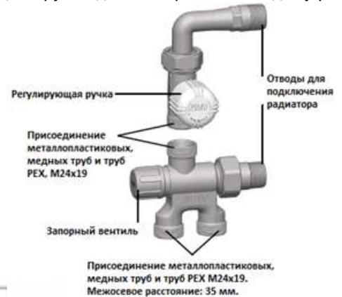
Присоединение металлопластиковых, медных труб и труб PEX M24x19. Межосевое расстояние: 35 мм.
