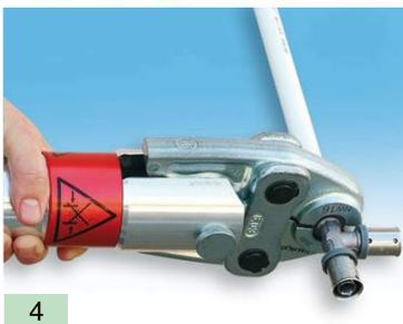
Необходимо проверить соответствие типоразмера трубы и фитинга. Монтаж металлопластиковых труб рекомендуется делать при температуре окружающей среде более +10°C.
