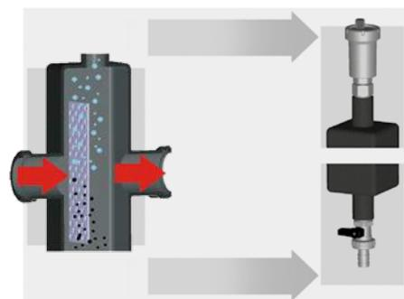
Внутри ёмкости ГР расположена перфорированная пластина-фильтр, на которой отделяются из потока шлам и пузырьки воздуха. Малая скорость жидкости в емкости позволяет пузырькам свободно всплывать вверх по пластине под купол емкости, где они далее удаляются автоматическим воздухоотводчиком, а шлам оседает на дно, и может быть выведен через сливной кран.
