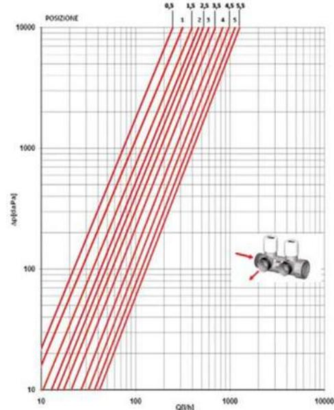
Вентиль позволяет произвести плавную и точную балансировку каждого контура в диапазоне пропускной способности от 0,3 до 1,2 м³/ч.
