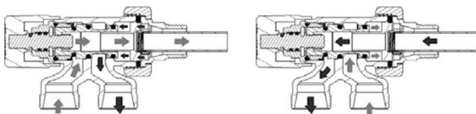
Подключение подающего и обратного трубопровода к узлу взаимозаменяемо.
