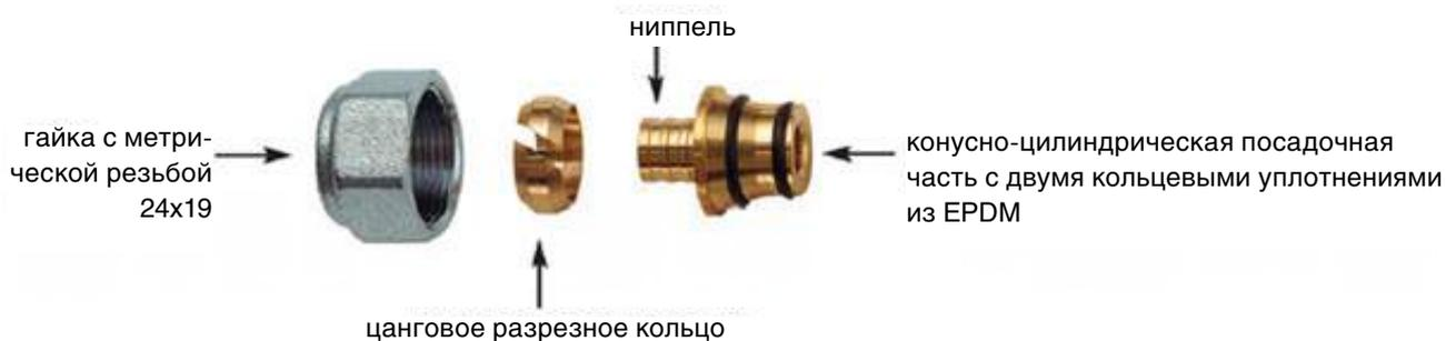
Концевки FAR позволяют подсоединять **напрямую медные трубы** диаметром от 10 мм до 22 мм включительно. Конструктивно концевки для медных труб представляют собой резиновые втулки из EPDM на внешнюю поверхность трубы. Их конусообразная форма сопрягается с присоединительным штуцером арматуры FAR с метрической резьбой.
