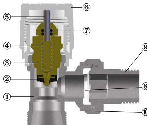
Терморегулирующий вентиль снабжен пластиковой регулирующей ручкой и может быть установлен вместо традиционных регулирующих вентилях. Ручная регулировка производится, начиная с полностью закрытого положения, переводом в открытое положение в соответствии с числом оборотов ручки.
