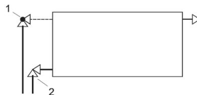
**Подключение радиатора по схеме «снизу-вниз»**
