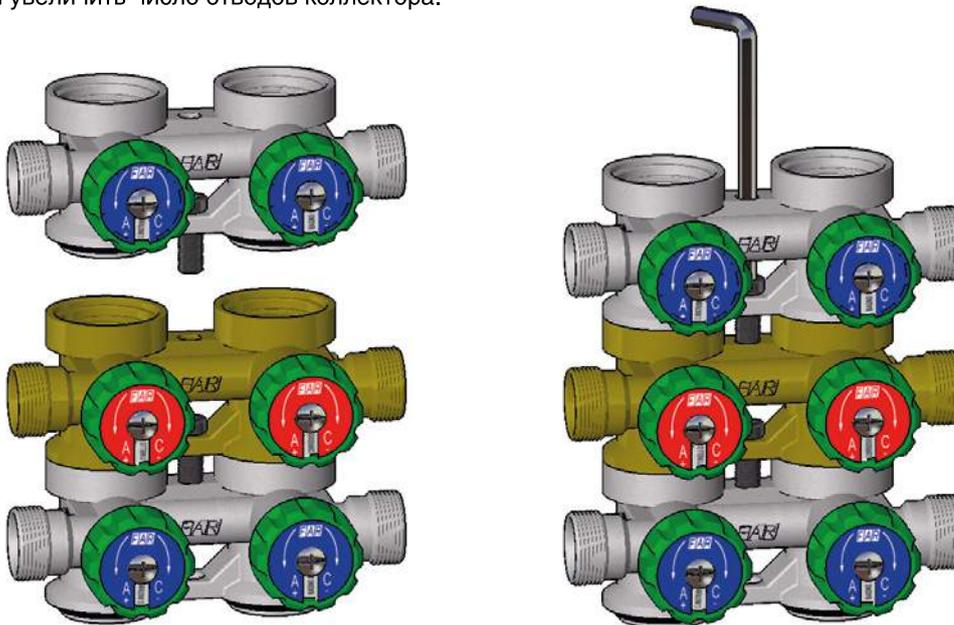
Вставить винт в отверстие между двумя соединениями, как показано на схеме.
