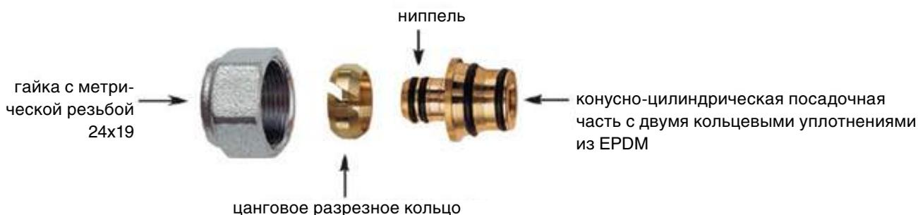
**Концевка FAR для металлопластиковых труб и труб PEX (код 6055)** с накидной гайкой с резьбой M24x19 имеет несколько отличительных преимуществ от стандартных концевок (типа eurokonus):
