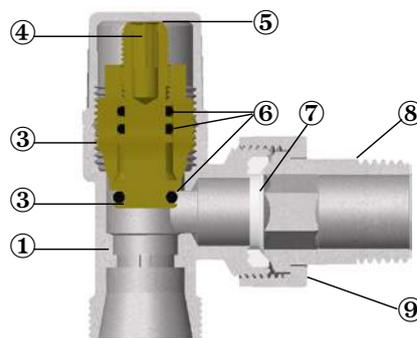
**Конструкция регулирующего вентиля с присоединением тип 1**
