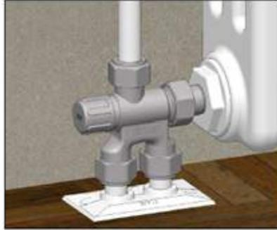
Пример установки узла с использованием термостатической головки.
