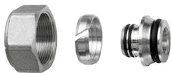
К отводам коллектора (код 3827), имеющим метрическую резьбу 33х1.5, **концовками FAR** (код 6056) **напрямую подсоединяются** металлопластиковые трубы 20х2, 20х2.25, 20х2.5, 26х3. Подсоединение металлопластиковой трубы 26х3 дает возможность прямо от коллектора делать разводку стояков и магистралей с допустимым расходом до 1100 кг/ч, при котором скорость теплоносителя не превышает 1 м/с.
