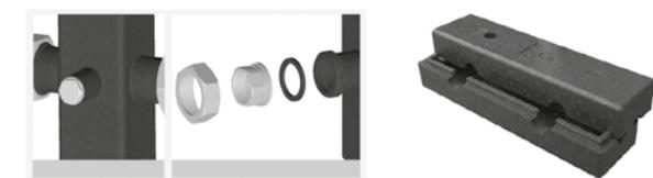
Штуцеры подсоединения контуров удобны для монтажа, так как являются разборными, состоят из фитинга, плоского кольцевого уплотнения и накидной гайки (код 2160). ГР может быть облачен в изолирующую противоконденсатную оболочку из вспененного полиэтилена, сформированную по форме ГР (арт. 2165).
