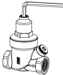
2) Повернуть монтажный ключ 5 мм против часовой стрелки и вытащить пружину
