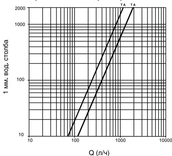
Kv=2,5 м³/час – коллекторы диаметром 3/4" – 1"
